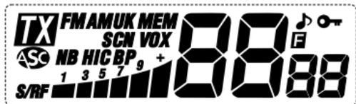
Многофункциональный дисплей отображает набор функций. Барграф показывает уровень приема и уровень выходной мощности.
