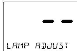
**Atención:** Los ajustes del retroalumbrado son: off, nivel 1 Dim, nivel 2 medio y nivel 3 luminoso.
