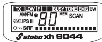
Il permet de visualiser l'ensemble des fonctions. Le BARGRAPH visualise le niveau de réception et le niveau de puissance émise
